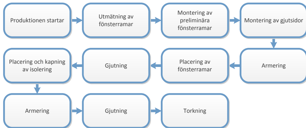
Figur 19 - Översikt processerna i gjuteriet.
