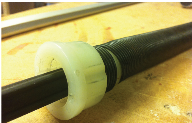
Figur 4. Fjäder med gängad plastbit i ena änden (t.v.) och plastkryss i andra änden.
