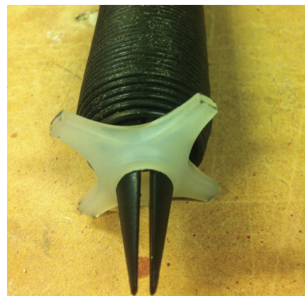
Figur 4. Fjäder med gängad plastbit i ena änden (t.v.) och plastkryss i andra änden.
