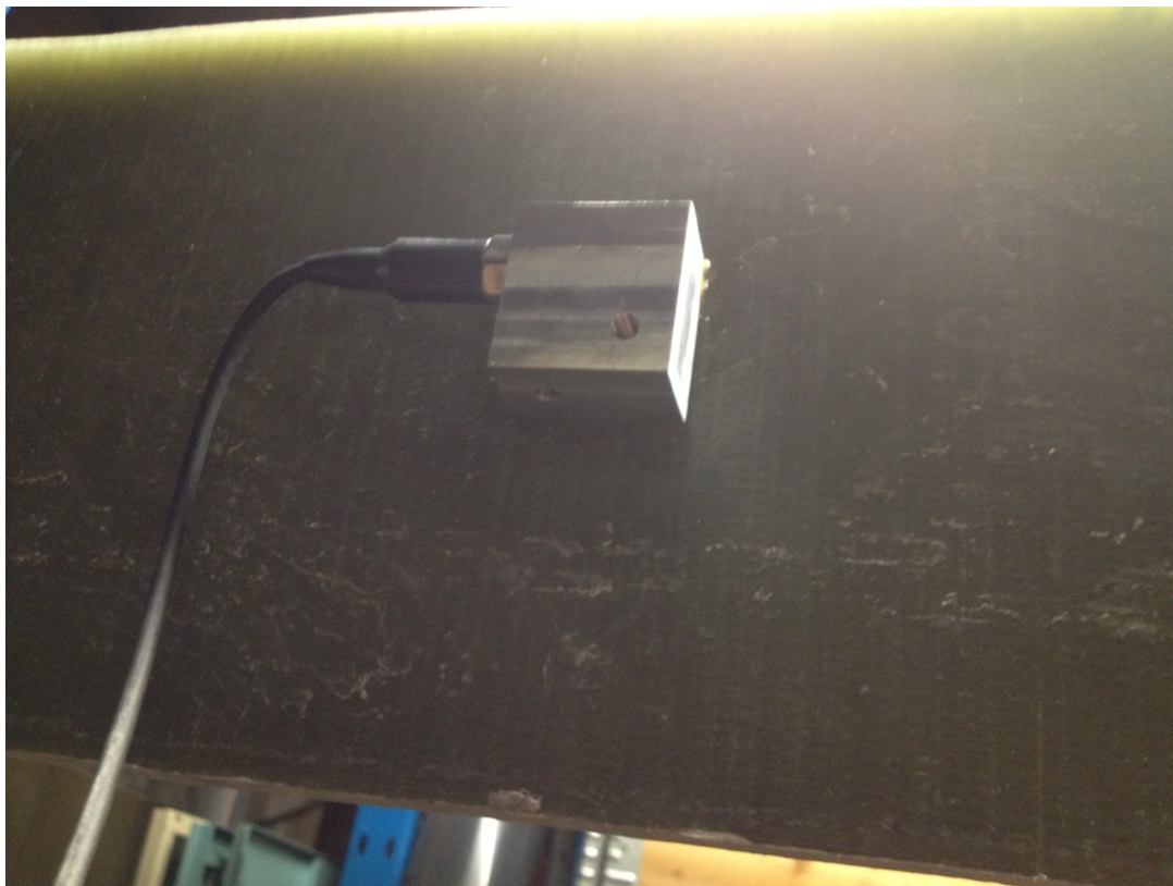
Figur 2.1.1: Visar ett sensorfäste där en sensor har monterats i ett av de tre gängade hålen.
