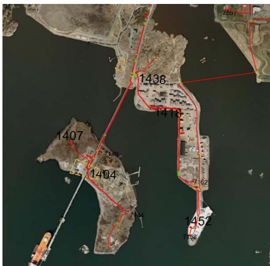
Figur 5. Figuren visar hur närliggande 10 kV kablar vid Vindplats Göteborg är förlagda idag.
