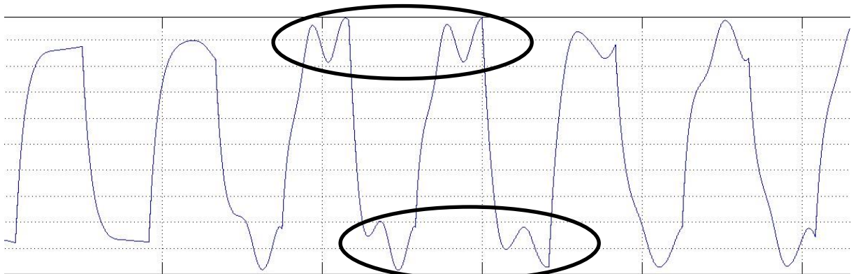
Figur 17. Överlagrade svängar hos strömkurva då stegmotor stannat
