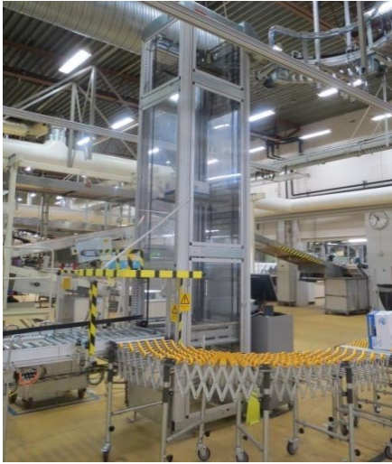
Figur 2.1 Färdiga lådor transporteras upp med hjälp av hissar.
