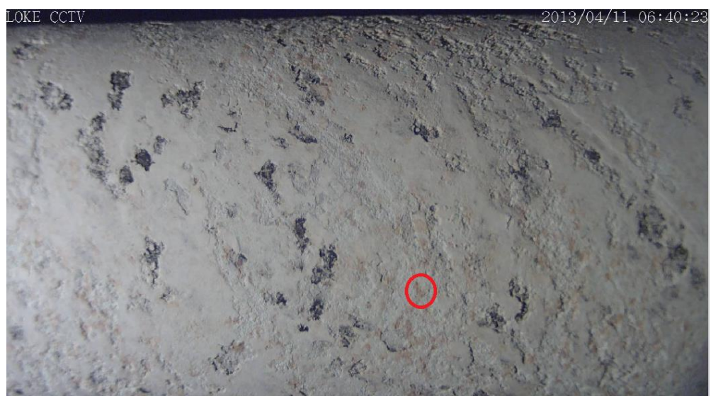
Figur 4.3: Ett utmarkerat ett rött område på sotblåsarlansen
