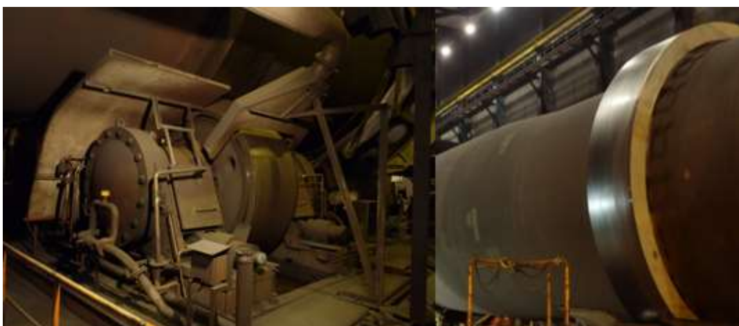
Figur 1.2. Den vänstra bilden visar ett av bärhjulen på KK3 och den högra bilden bärringen på KK4. Bärhjulen ligger inte direkt mot kilns mantel utan mot bärringen som är trädd runt kiln.
