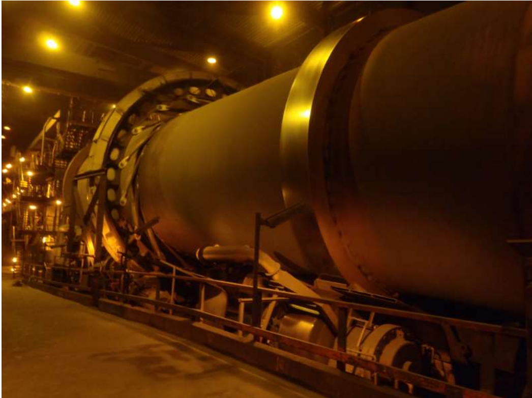
Figur 1.1. Kiln i kulsinterverk KK3, kiln är en roterande högttemperatursugn. Kiln på bilden är 33,5 meter lång och har en diameter på cirka sju meter.
