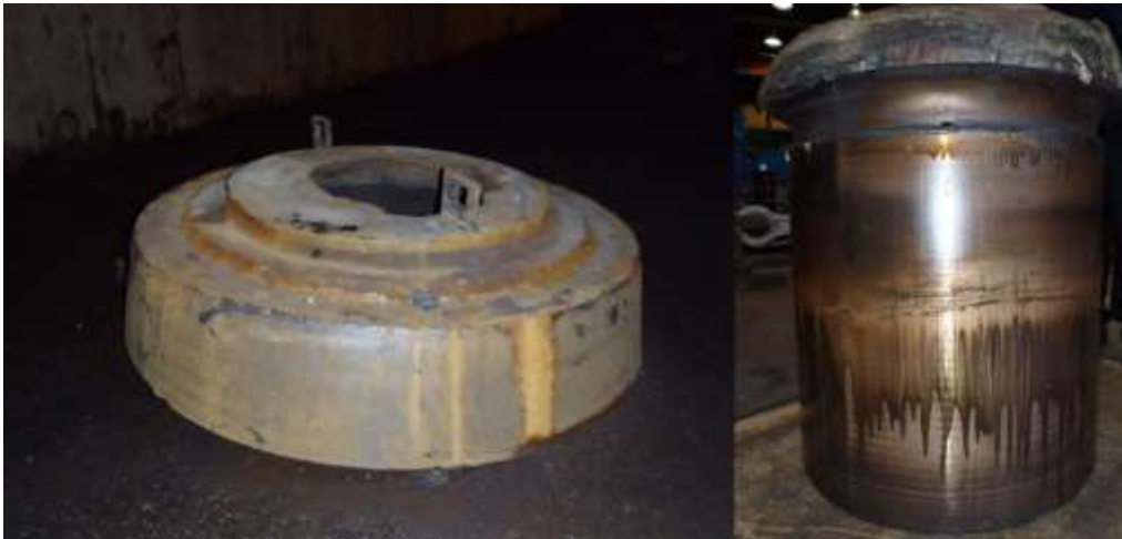
Figur 1.7. Två bilder från stödhjulshaveriet augusti 2011. Den vänstra visar överdelen och den högra visar axeln.
