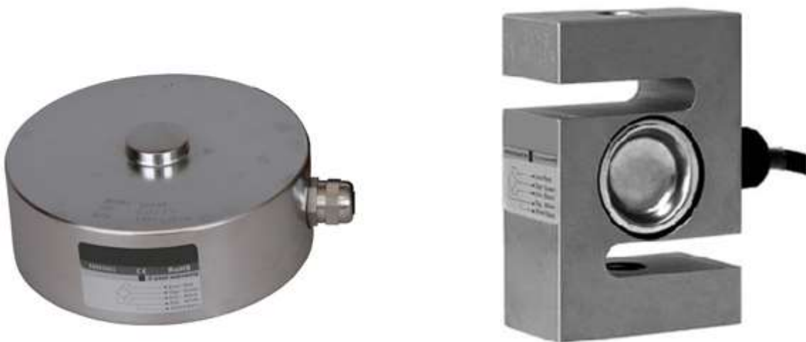
Figur 2.5. Två lastceller: den vänstra är en lastcell för tryckkraft avsedd för bland annat tankar och silos. Den högra är en S-lastcell, anpassad för tryck- och dragkrafter. Bilderna är hämtade från Veteks hemsida. Länk: http://www.vetek.se
