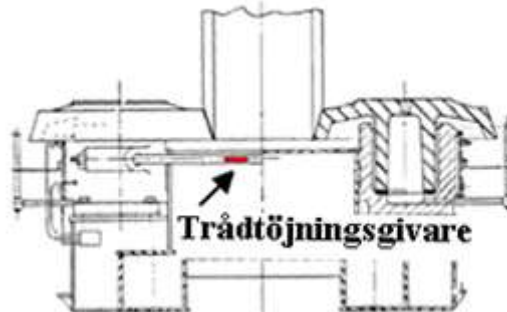
Figur 4.15. Skiss över stödhjulen, lagerhusen och bärringen där trådtöjningsgivarens tänkta placering är utmarkerad.
