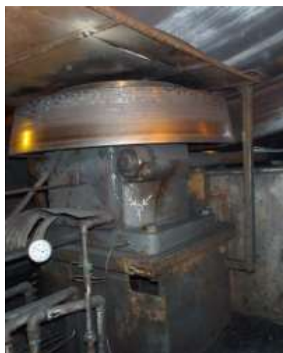
Figur 1.4. Bild på ett av stödhjulen på KK2. Stödhjulets uppgift är att förhindra axiell förflyttning av kiln.
