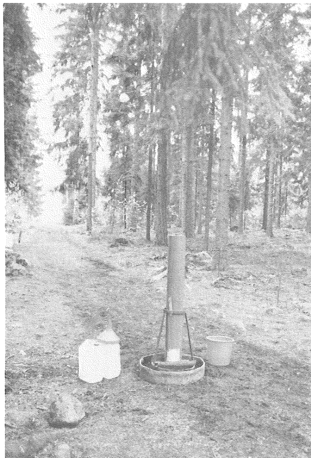
Ringinfiltrometerförsök på motionsslingan i södra delen av planområdet. Relativt art- och individfattig vegetation, mossor dominerar helt markvegetationen. Foto: Bo Lind.
