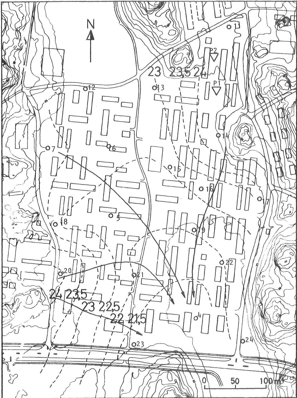
Figur 26. Karta över grundvattnets ungefärliga strömning i Bratthammar 761108. Streckade linjer anger grundvattentrycknivån (m ö h). På kartan anges även observationsrören.
