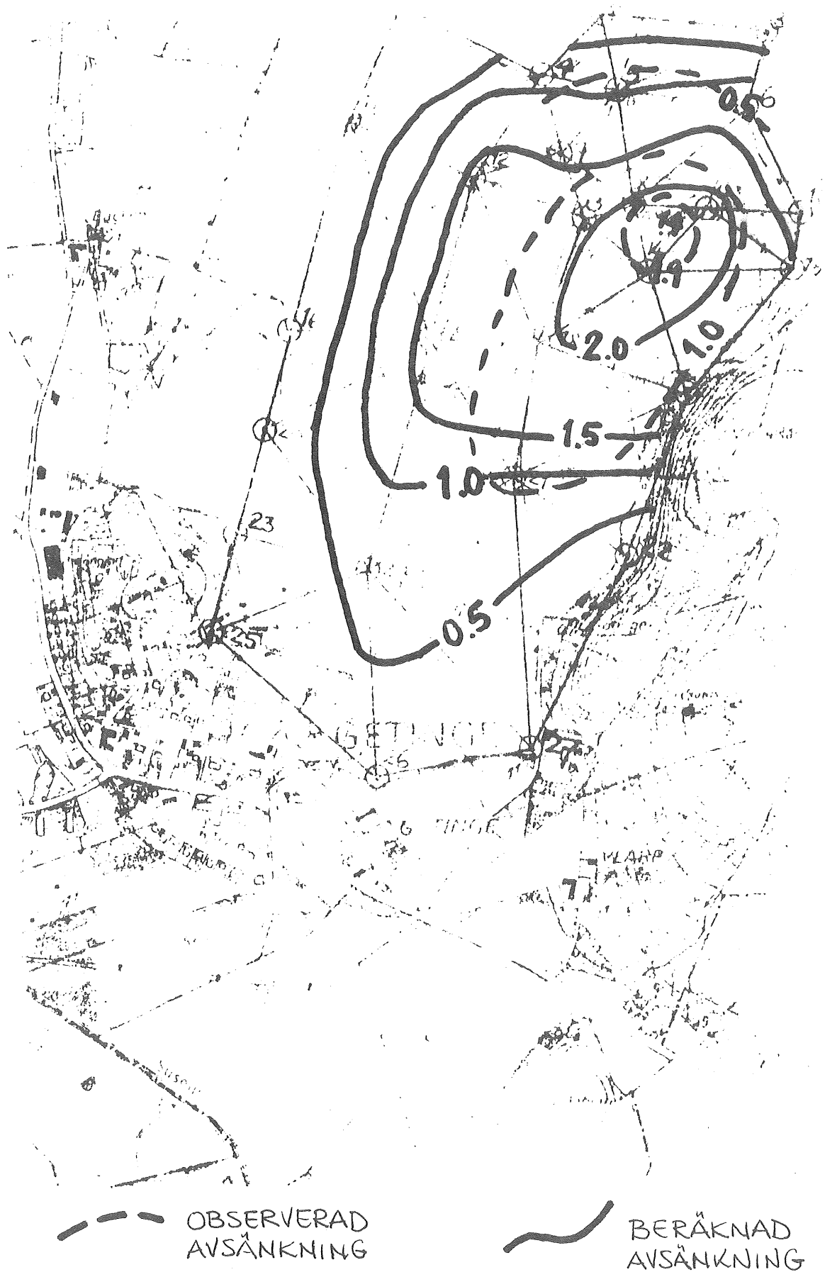
FIG. 4.2.14. Exempel 3 - slutlig avsänkning vid pumpkapacitet 5 l/s.
