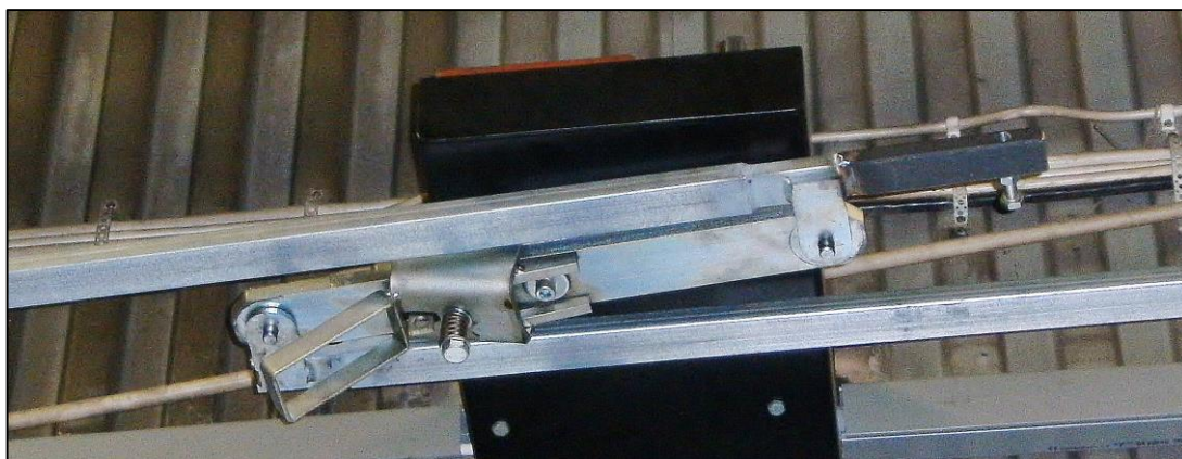
Figur 6.10 - Bild som visar drivarmarnas infästning i propellern. I övre högra hörnet ses den mekaniska överslagsstoppen som tidigare omnämnts, denna har i det här fallet monterats i efterhand. Anordningen med handtag som sitter på propellern är den mekanism som används för att frikoppla propellern från motoraxeln.
