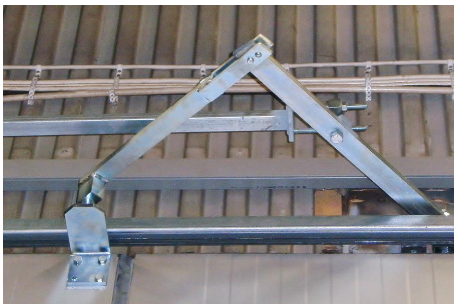
Figur 6.11 - Bild som visar drivarmens infästning i vridarmen. Längdinställningen skymmas bakom vridarmen.
