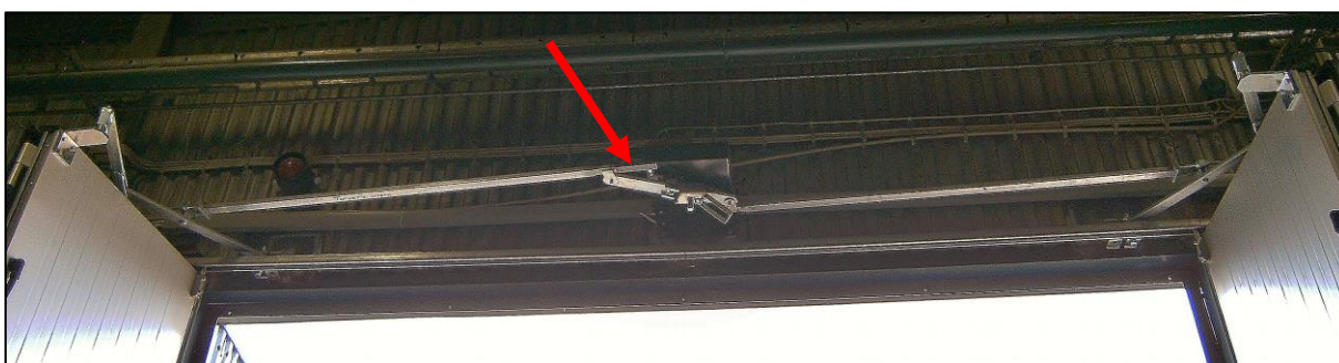
Figur 5.10 - Bild som visar det provmonterade systemet i öppet läge. Pilen pekar på överslagsstoppen som i detta läge kommer att förhindra propellern från att vrida sig ytterligare.
