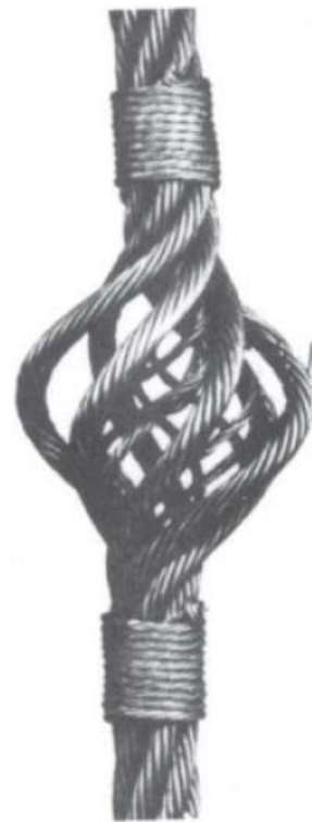
Figur 3.4 Visar en vajer som blivit utsatt för bird caging.
