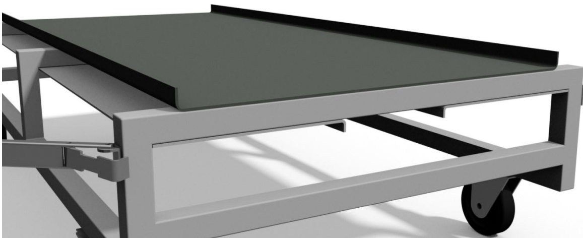
Figur 8.16 Lastvagn med hål för gafflarna på en truck, med en plåt ovan, plåtar för gafflarna under. Lastvagnen är utrustad med hjul och är 300 mm hög så den passar med monteringsbordet samt en horisontell profil som motverkar att lastvagnen välter när enheten körs av lastvagnen.
