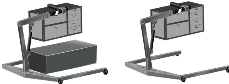
Figur 5.15 Verkstadskran i buffert med och utan lastpall
