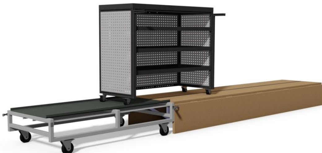
Figur 8.18 Enheten har utrustats med hjul på gavlarna och lastvagnen har rullats fram till monteringsbordet. Enheten rullas sedan över till lastvagnen för att rullas till buffert och sedan till fordon för inlastning
