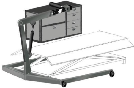
Figur 5.12 Verkstads-kran hämtar enhet vid monteringsbord
