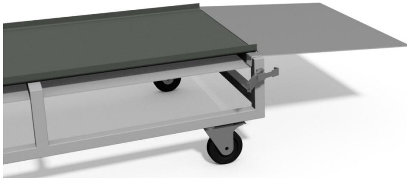
Figur 8.17 Ramp som sätts på lastvagnen vid inlastning
