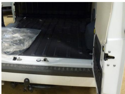
Figur 3.9 Upphöjningar, dragkrok och tröskel
