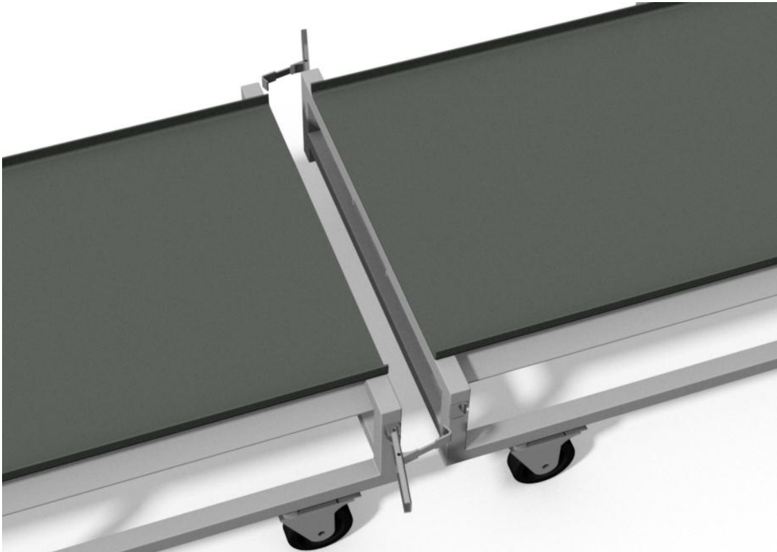
Figur 8.15 Excenterlåsen liksom fästena sitter diagonalt placerade mot varandra vilket gör att lastvagnen inte går att ställa åt fel håll vid hopsättning.
