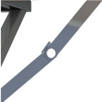
Figur 8.3 Gångjärn vinklat lite över 180 grader och låser med en klack
