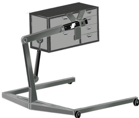
Figur 5.13 Verkstads-kran med lyft från sidan med Y-fästet
