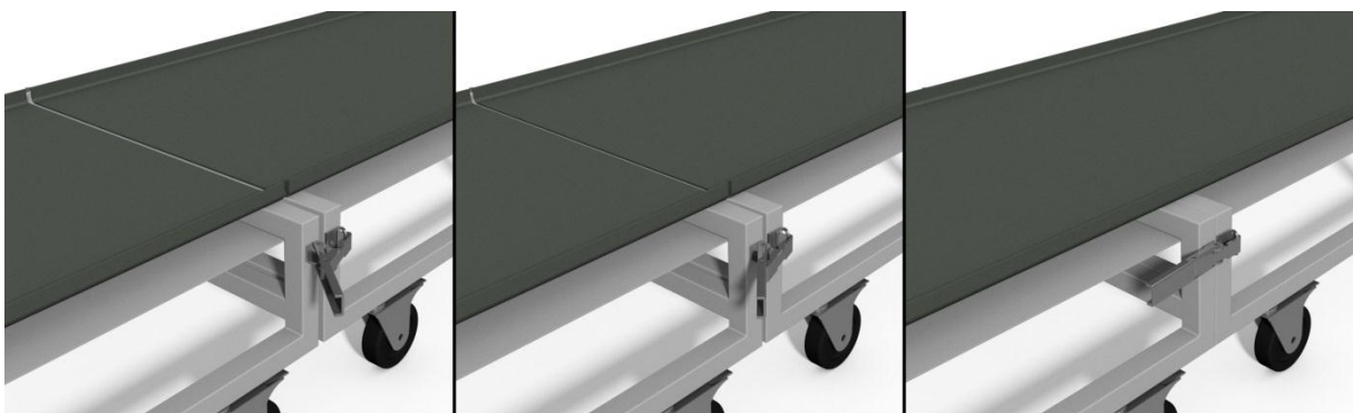
Figur 8.14 Lastvagnen sätts ihop på rad med excenterlås
