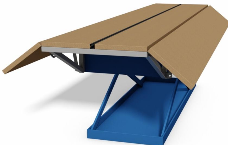
Figur 8.2 Monteringsbord med nedfällbara skivor med skivor i lätt nedfällt läge
