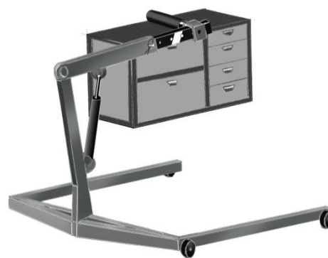
Figur 5.14 Verkstads-kran med lyft ovanifrån
