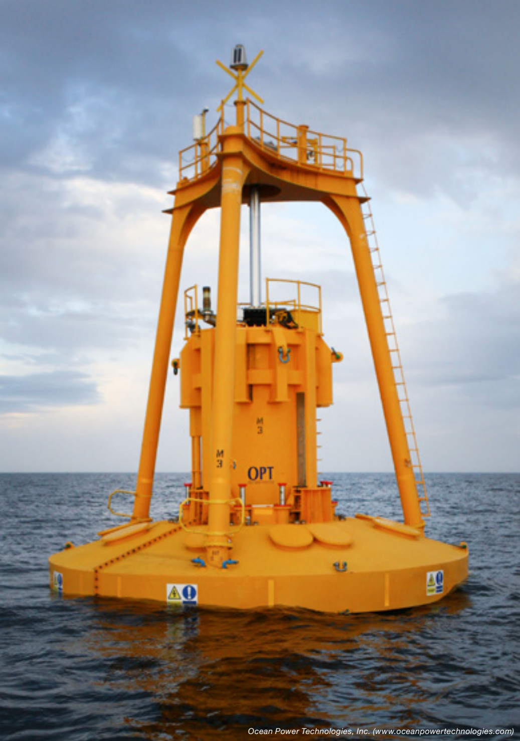
Vänster: Vågkraftverket Power-Buoy från det amerikanska utvecklingsbolaget Ocean Power Technologies.
