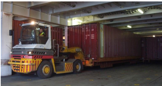
Figur 4. Terminaltraktor lossar en SECU från RoRo-däck (Martinsson, 2012)
