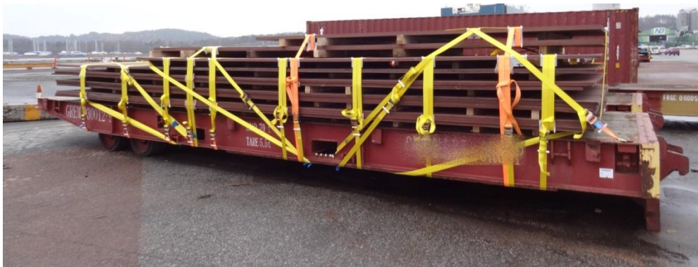
Figur 2. En rolltrailer med fastsurrade metallplattor (Martinsson, 2012)
