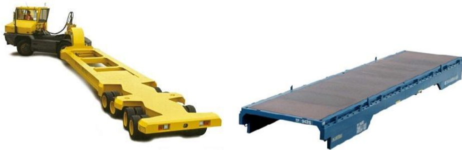
Figur 3. Translifter och en kassett (TTS group)
