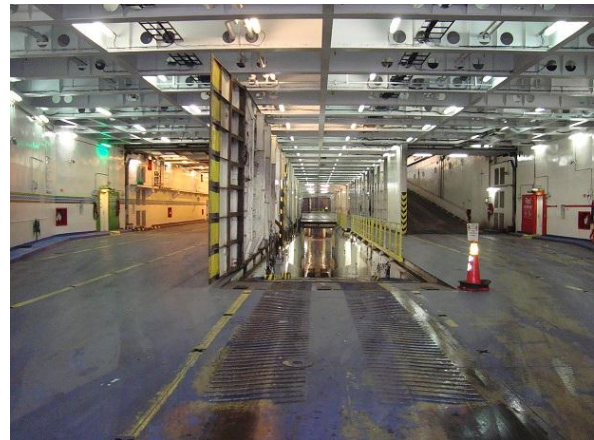
Figur 2. Lastdäck med höj- och sänkbara ramper (Åberg, 2012)
