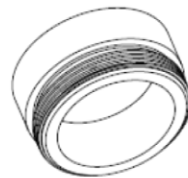
Utvändig gänga med längd 8 mm ska passa med gänga på detalj alurör
