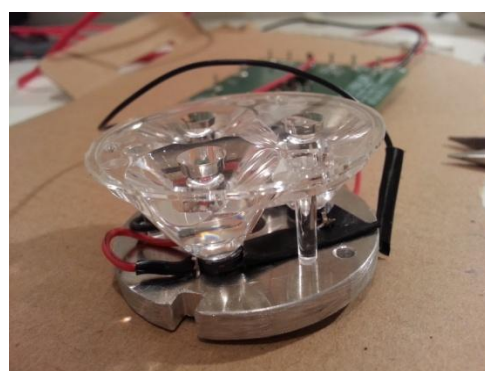
Bild 23. Montering av LED-lins på kylplatta
