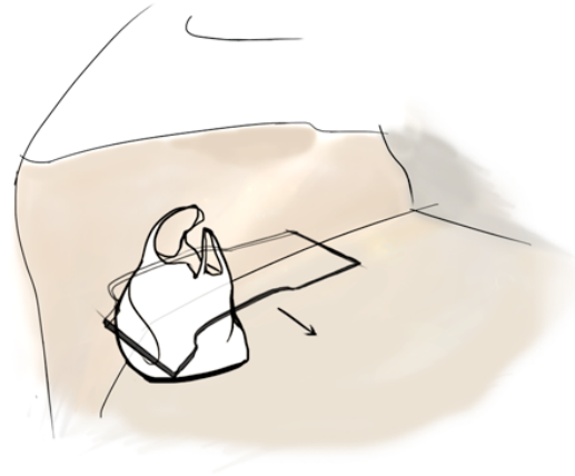
Fig. 5.4 Alternativa hållare för matkassar där ingrepp på lastgolvet undvikts för att underlätta användning av golvtäckande tillbehör. Först ett utdragbart rutsystem av elastiska band eller textilband för stöd för matkassar och liknande, sedan en utdragbar aluminiumbygel med samma syfte.
