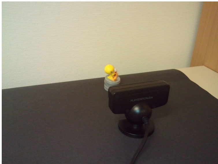
Figur 8. En svart yta används för att filtrera bort oönskade punkter under skanning.
