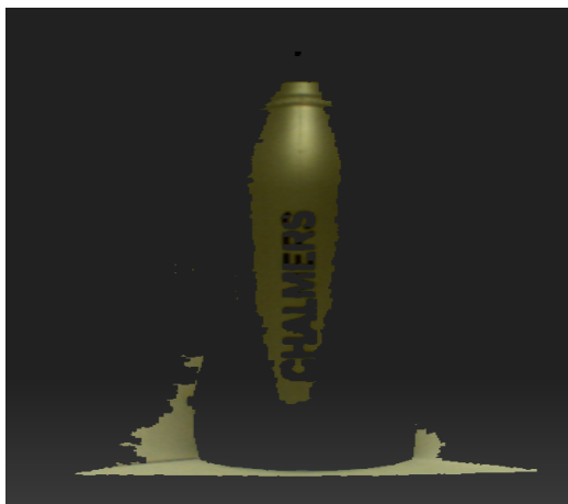
Figur 38. 0.5 litersflaska med Chalmers logga skannad med DAVID laserscanner.
