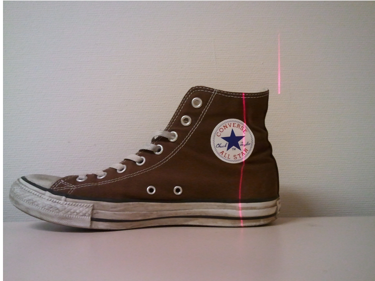
Figur 2. Avståndet mellan dem två linjerna räknas om till avstånd för varje enskild punkt från väggen.
