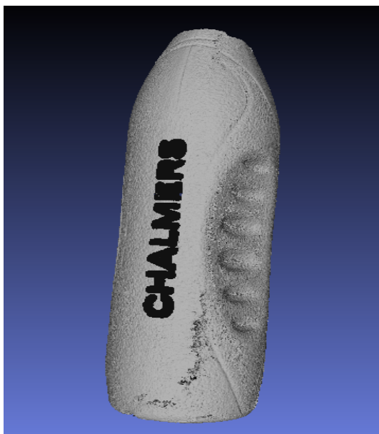
Figur 52. 0.5 liters flaska med Chalmers logga skannad med strukturerad ljus teknik.
