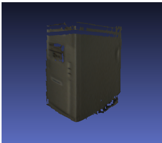
Figur 44. Vitt datorchassi skannad med DAVID laserscanner.
