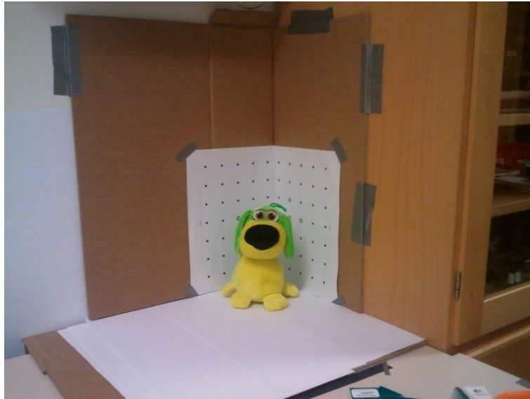
Figur 7. Skanningsbås med mönster för kalibrering och Skanningsföremål.
