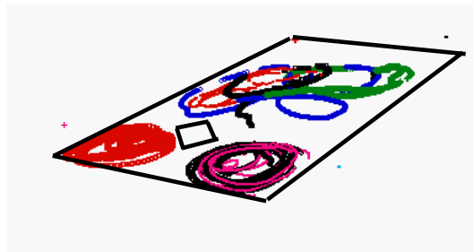
Fig. 9.1.1.2.3 Uppmätt strömningsmönster ur två kameravinklar för Hinder 4 vid flödet 20 l/s, 85 cm under vattenytan.
