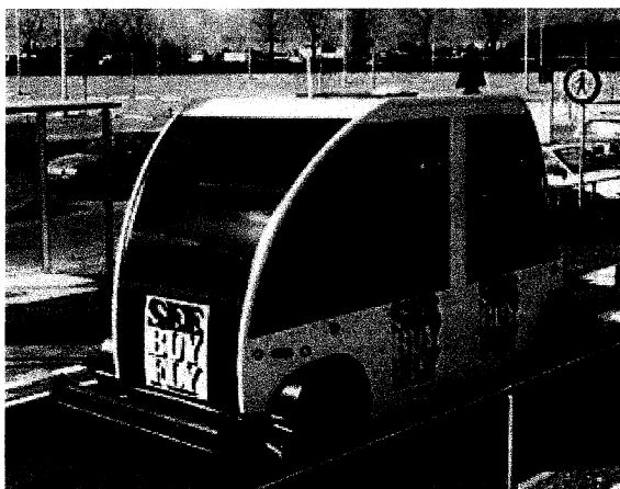
Figur 5.1: Frog Park Shuttle på Schiphol-flygplatsen. En automatisk minibuss som är eldriven och styrs av nedfrästa slingor i marken.
