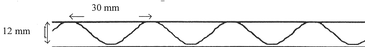
Figur 9. Utseende på de plastskivor som placerades mellan lamellerna. 12 mm avser höjden på plastskivorna.
