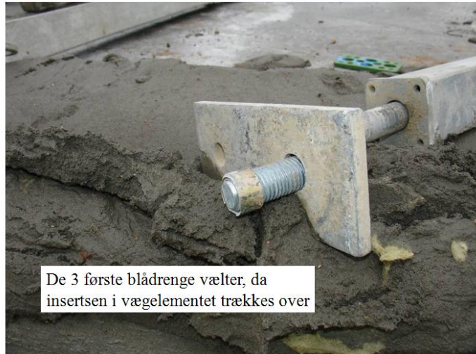
Billede 10: Inserts - fra NCCs udredning af ulykken, 14. januar 2008.
