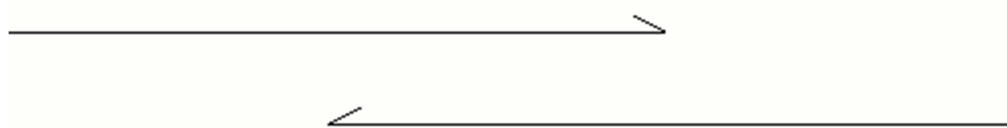
Figur 14 - Skarv/överlappning av armering i ritningsläget
