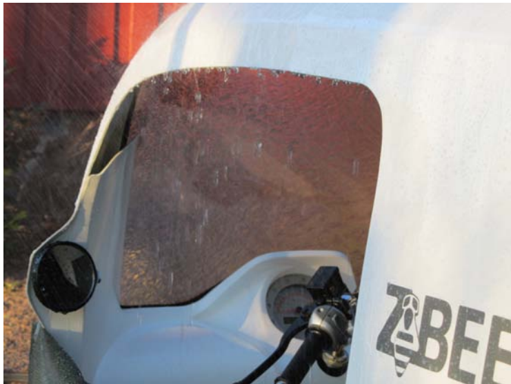
Figur 4.1 Regndroppar faller från taket in i kupén under regntest.
