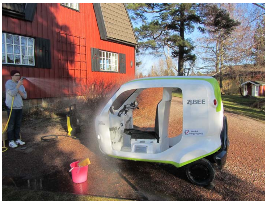
Figur 3.2 Vatten sprutas på Z-Bees framruta för att illustrera regn i 45km/h.
