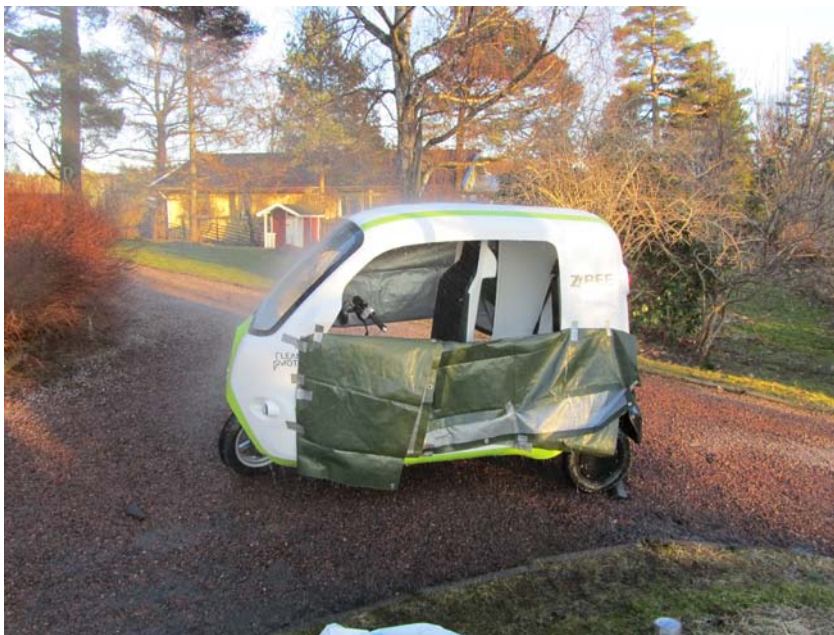
Figur 3.3 Z-Bee med presenning på nedre delen av dörröppningen under regntest.
