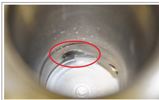
Figur 33: Koppen med hålet som bildats till vänster (inringat), tvärs över det tangentiella inflödet. Notera också att inblåset från kapillären inte ligger direkt an mot botten av koppen som önskades.
