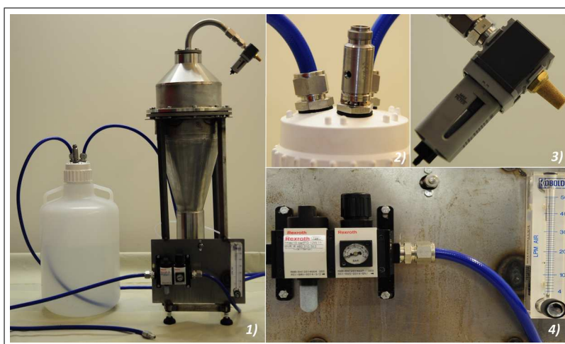
Figur 21: Bild 1: hela testanordningen färdigmonterad. Förstorade bilder på säkerhetsventil, filter och instrumentplatta; bild 2, 3 respektive 4.
