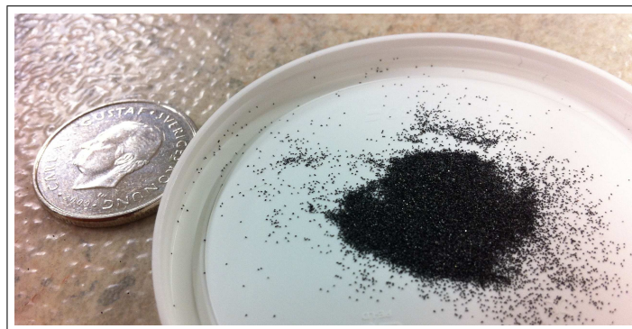
Figur 23: Färska ilmenitpartiklar. Notera storleksordningen och att detta är partiklar som ännu inte nötts ner. Bulkdensiteten är 2,50 \text{ g/cm}^3 , partikeldiameter mellan 125-180 \mu\text{m}
