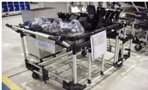
Bild 8: Modulär plockvagn från Volvo Bussars fabrik i Brasilien Källa: Volvo Bussar
