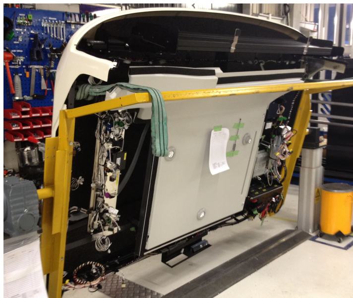
Bild 2: Färdigmonterad takmodul i monteringsställning på P021 Källa: Bild tagen av kandidatgrupp
