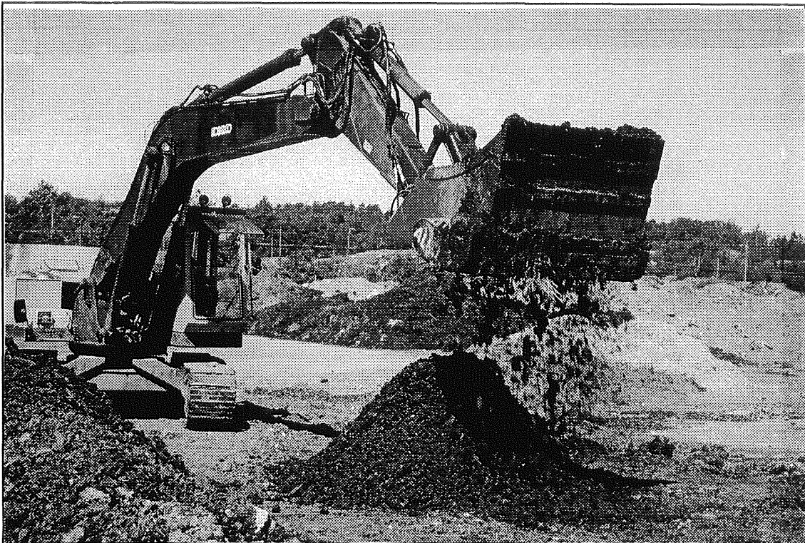
Figur 2.4 Siktrosskopian är försedd med roterande valsar i botten. Med denna grävdes strängkomposten om från och med den tredje omgrävningen, dag 166 (4juni).
