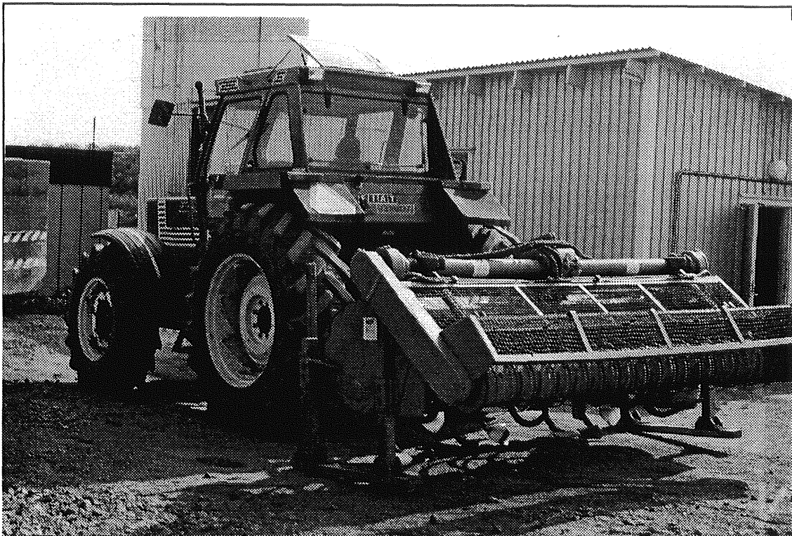
Figur 2.3 Spadingmaskinen, med vilken bäddkomposterna blandades och grävdes om. Den fungerar som en stor jordfräs.
