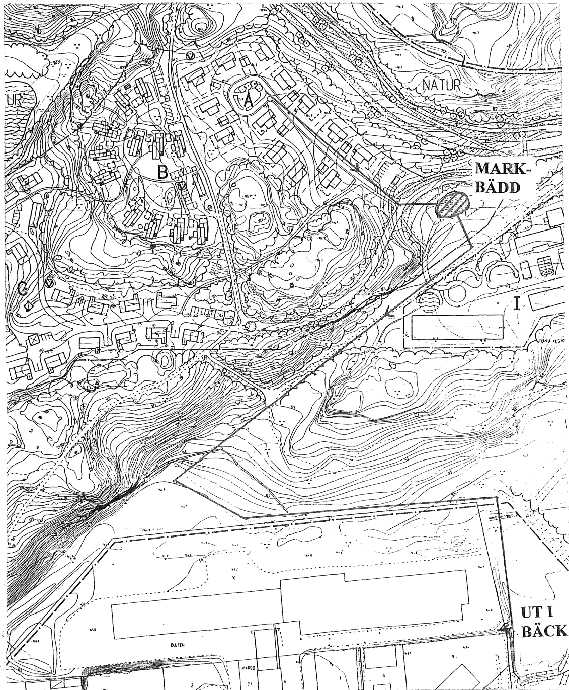
Figur 14 Karta med markbädds placering och ledningsdragning (förslag 1 för område A)
