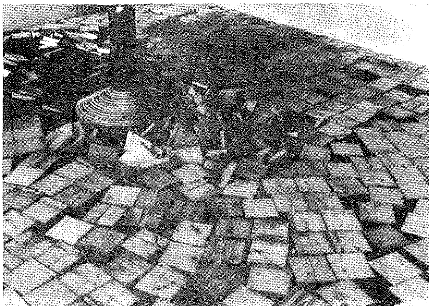
Fig.14 Försök 18. Fyrmodell A3 utsatt för modellis av drivistyp.
