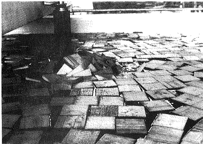
Fig.13 Försök 16. Fyrmodell A2 utsatt för modellis av drivistyp.
