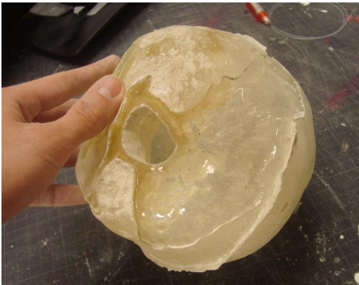
Figur 5. 15 - Gjutdefekt på skallmodellen.
