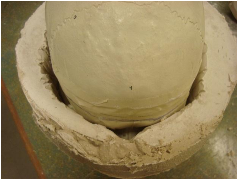
Figur 5. 8 - Felet mellan skallmodell och formens undre del.
