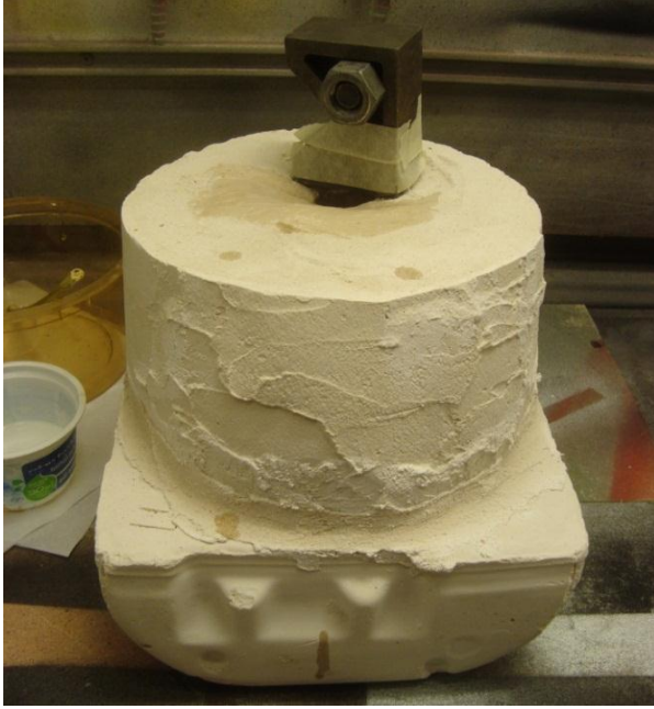
Figur 5. 14 - Gjutformen då den fyllts med epoxi.
