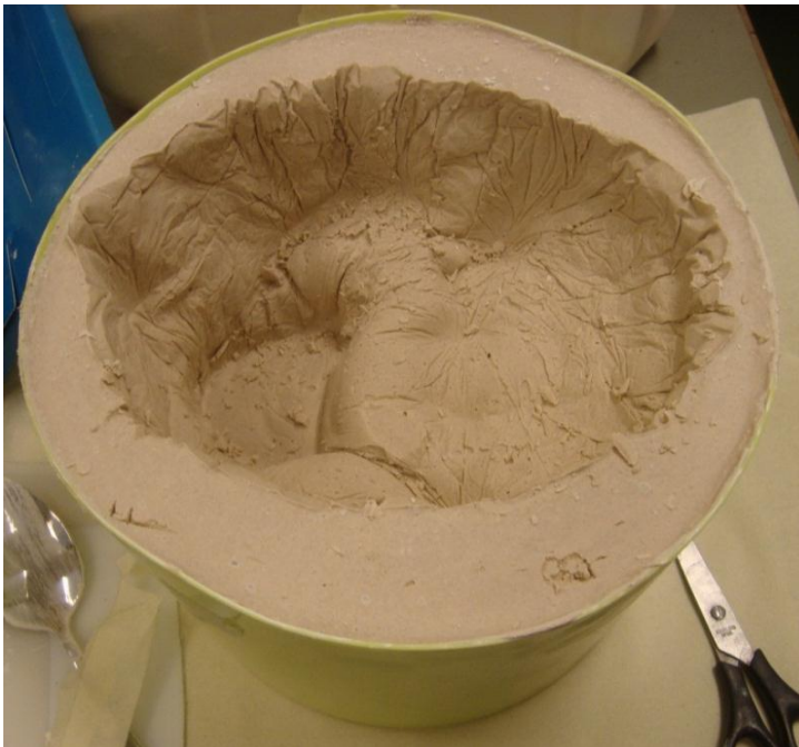
Figur 5. 7 - Formens undre del efter att skallmodellen har avlägsnats.
