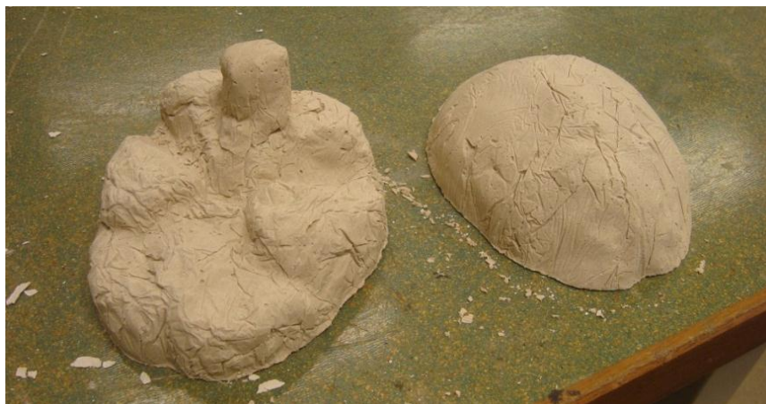
Figur 5. 11 - Kärnhalvorna efter att de tagits ur skallformen.
