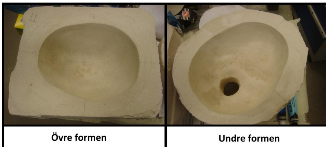
Figur 5. 9 - De färdiga formhalvorna.
