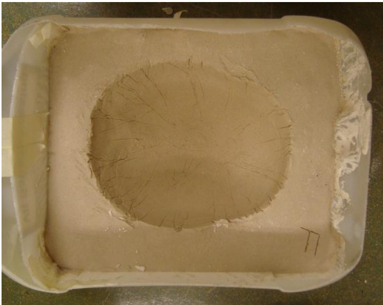
Figur 5. 5 - Formens övre del efter att skallmodellen har avlägsnats.
