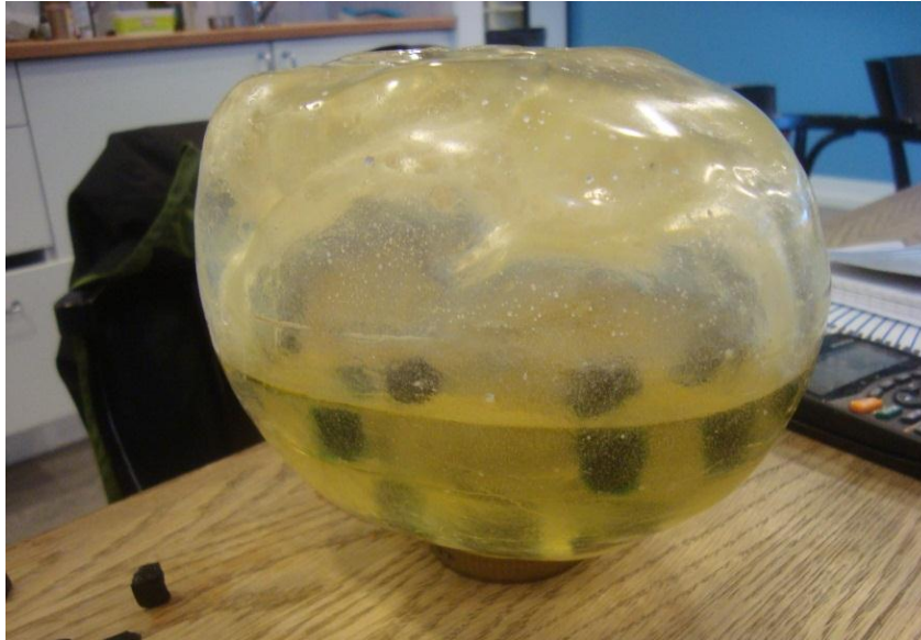
Figur 5. 18 - Påfyllnad av hjärnsubstitutet.
