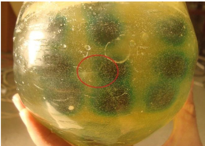
Figur 8. 1 - Sprickbildning på skallmodell.
