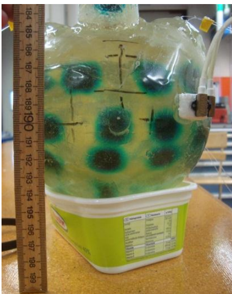
Figur 7. 3 - Huvudmodell med referensstreck och accelerometrar.
