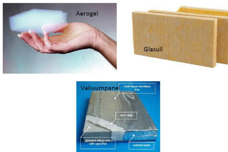
Figur 7: Olika varianter av isolering (Nasa, 2012) (XL bygg, 2012) (De store bygningers økologi, 2012)
