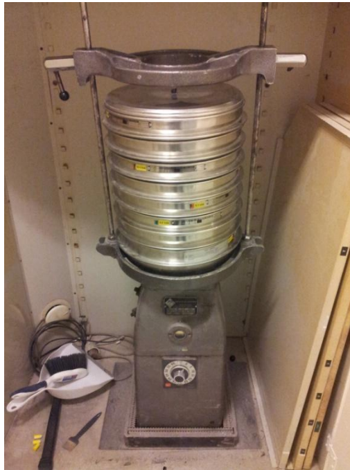
Figur 2 - Siktmaskin med 8 siktdäck
