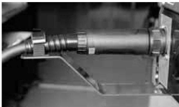
Figur 4.28: Kabelinfästning samt dragavlastare för svetspistol.
