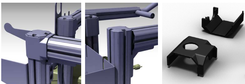
Figur 8.13: Koppling, skarv och plastkåpa.
