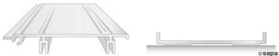
Figur 8.10: Feleffekter och räfflade ytor.
