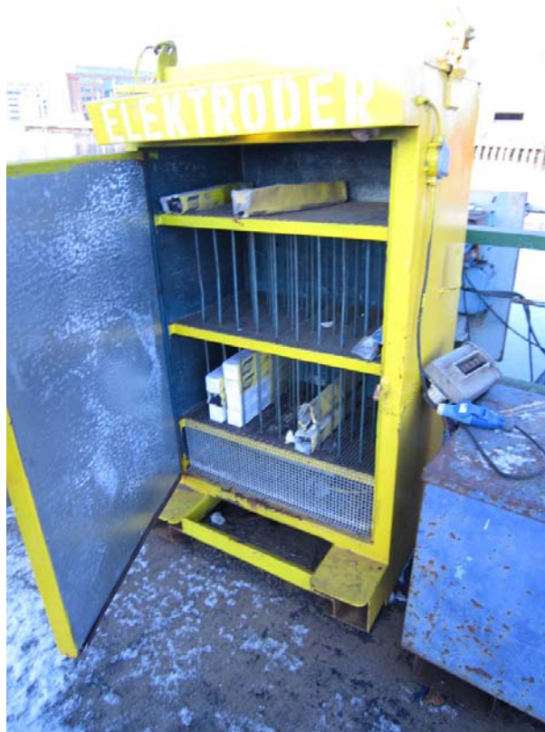
Figur 4.13: Elektrodförvaringsskåp på Cityvarvet, Göteborg.
