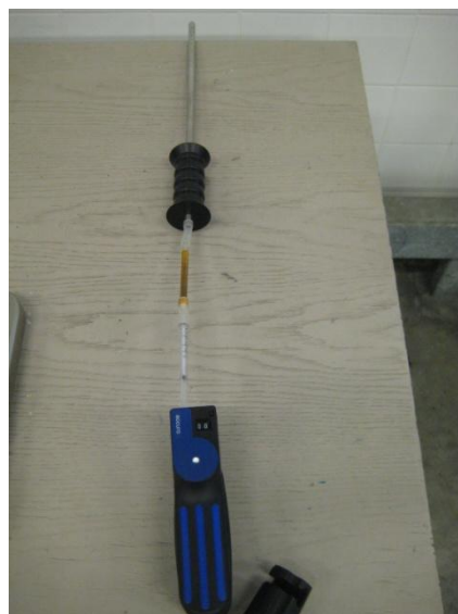
Figur 5 och 6. Visar hur mätningarna utfördes på öppnade containrar samt den anordning som användes vid mätning. I just det dokumenterade fallet i Figur 5 skedde mätning av Fosfin medan det i Figur 6 är rör för mätning av Sulfurylfluorid som är inkopplat.
