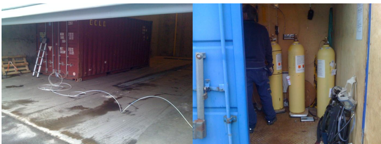
Figur 13 och 14. En smalare ledning kopplades från gastub till containern som skulle gasas med Sulfurylfluorid.
