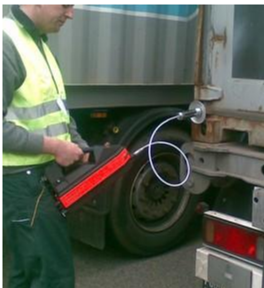
Figur 23 och 24. Visar mätinstrumentet GDA 2 samt dess användning vid mätning utav luft i containrar.
