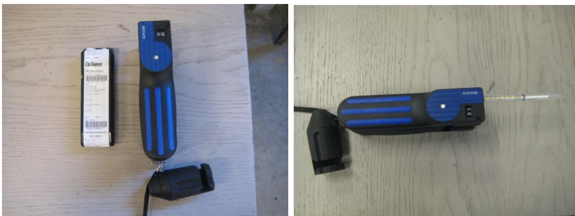
Figur 1 och 2. Visar handpumpen Accuro med tillhörande förpackning för reagensrör samt ett inkopplat reagensrör för mätning utav Fosfin.
