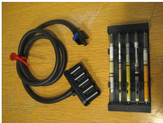
Figur 22. Ett speciellt fumigationsset samt det tillbehör som används för att koppla in detta.
