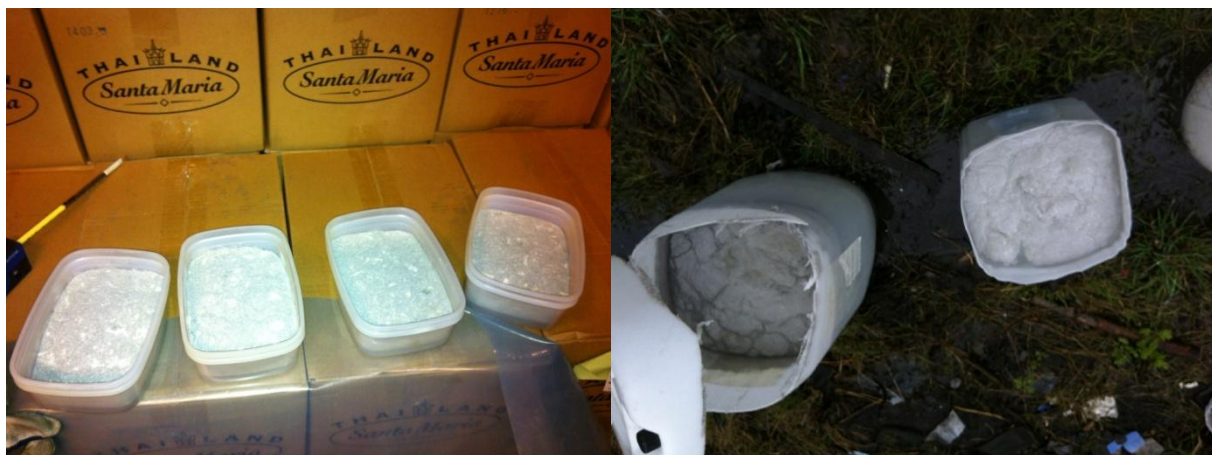
Figur 11 och 12. Restprodukter efter gasning med Fosfin utgjordes av ett gråvitt pulver av Aluminiumhydroxid, vilket släcktes i vatten för att oskadliggöras.
