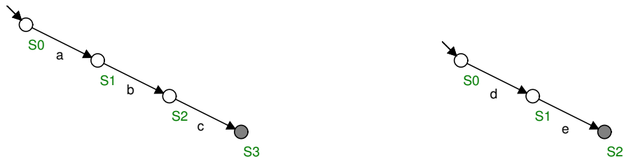
Figur 2: Robot R_1 s (vänster) och R_2 s (höger) händelsemängd visat i den ordning de kan utföras. Initialtillstånd markeras med pil, sluttillstånd markeras i grått.
