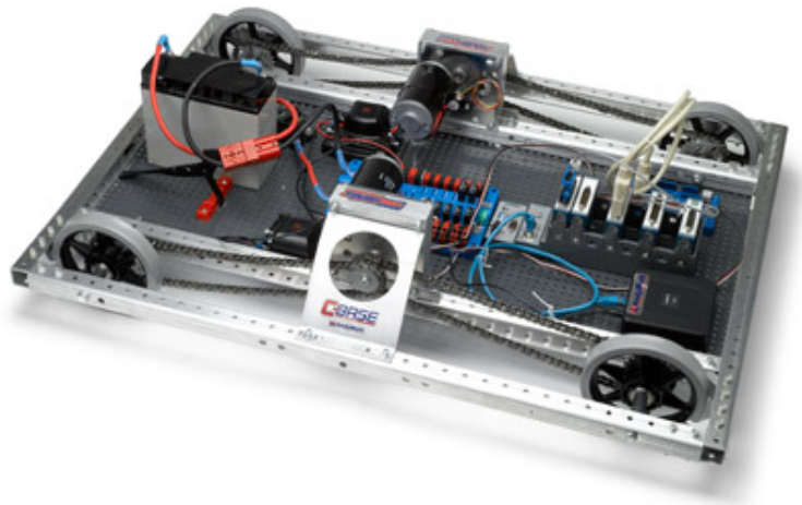
Figur 1.1: Den befintliga plattformen är ett NI Robotics CompactRIO Kit vilken är utvecklad av National Instruments i syfte att skapa en enkel grund för studenter att programmera och vidareutveckla.
