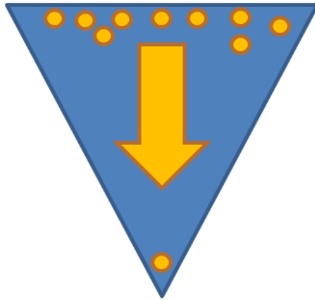
Figur 2.1.2: Set-based-metod: Principbild över lösningsgång. Startar med en mängd lösningar som gradvis minskas ned då detaljnivån ökar. Lösningsmängden konvergerar till en optimerad slutlösning.
