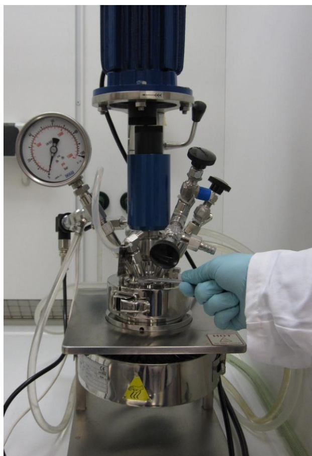
Figur 8: Autoklaven som användes vid tillverkningen av karboxylsyror.
