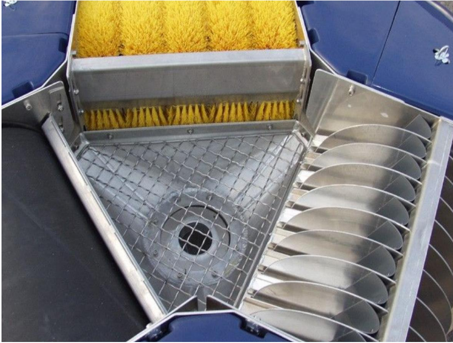
Figur 2.4 En multiskimmer från Lamor med disk/borst/trum-funktion.
