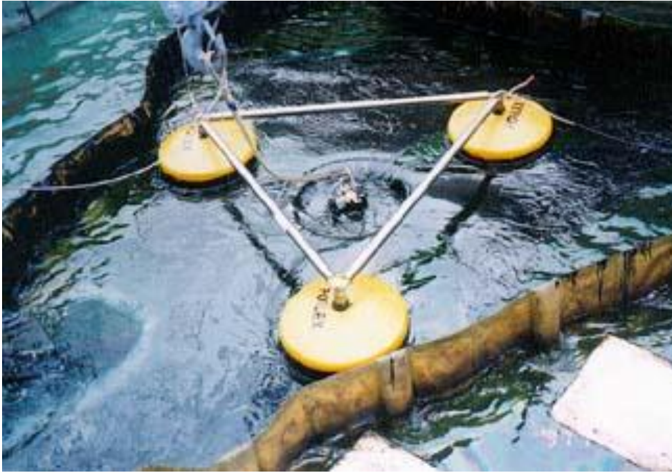
Figur 2.2 Flytsystemet håller en överfallsskimmer flytande mellan skikten av olja och vatten som sedan pumpar upp oljan till en förvaringstank.
