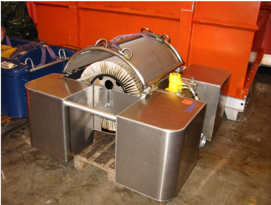
Figur 2.5 En multiskimmer från Markleen med borste monterad. Borsten kan bytas ut mot diskar eller trumma.
