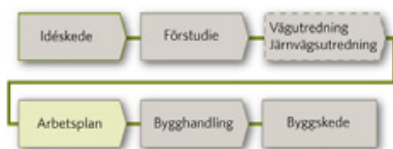
Figur Processen Byggnade av järnväg. (ill: Så blir väg och järnväg till, Trafikverket)
