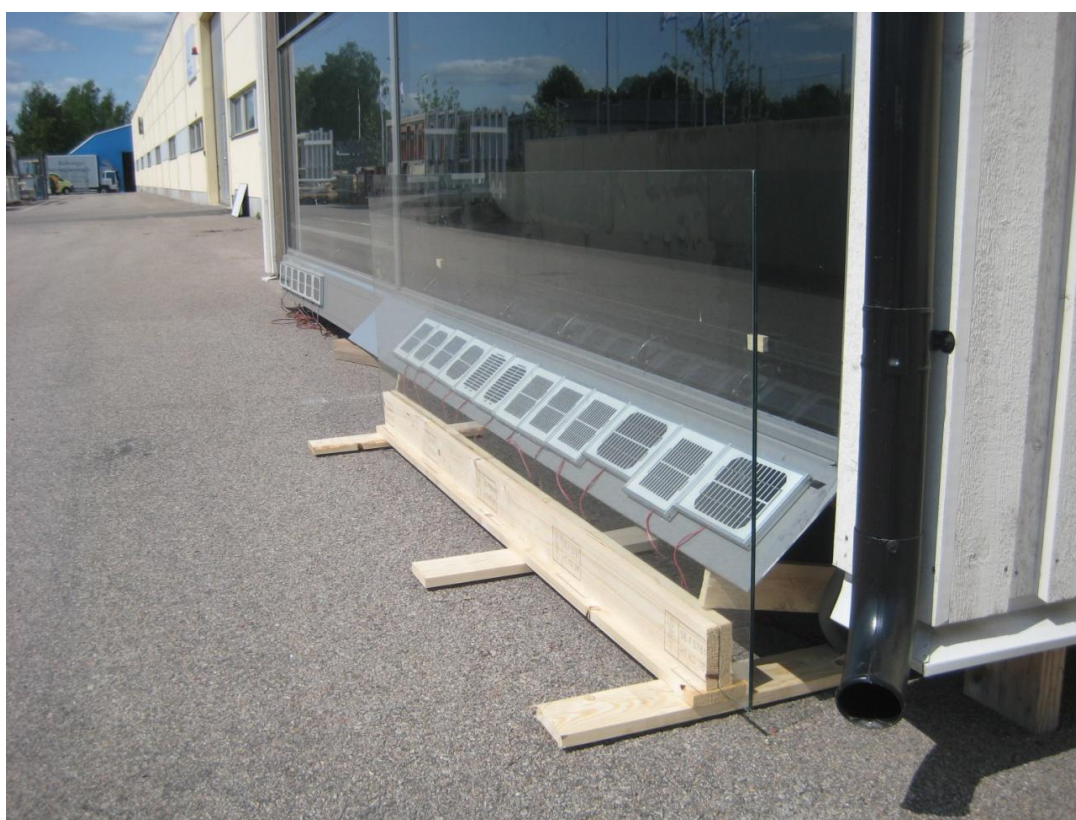
Figur 7.3 Vidareutveckling av prototyp 1 och 3 med vinklade solceller
