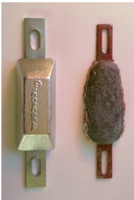
Figur 17 – En ny offeranod till vänster och en gammal offeranod, som ska bytas, till höger [17] (Tillstånd från ägaren att använda bilden.)
