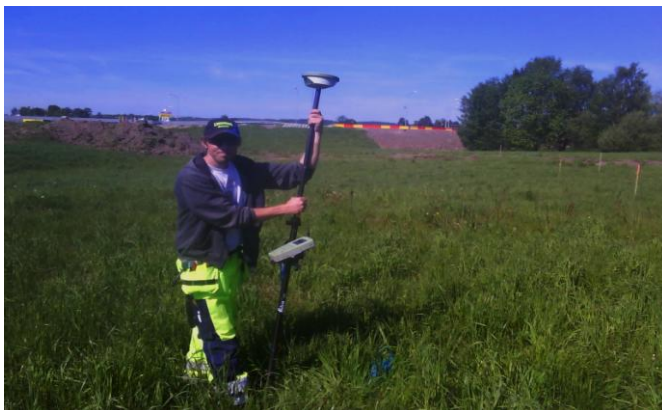
Figur 11. Mättekniker Kjell Danhard från NCC med en Rover som är ansluten till handdatorn (eget foto ifrån praktik vid NCC).
