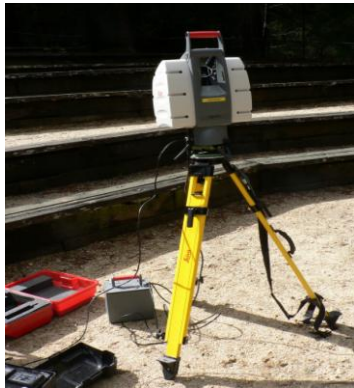
Figur 14. Laserscanningsinstrument uppställt (Geomatiknyheter – Generera 3D-bilder från digitalfoton 2009).
