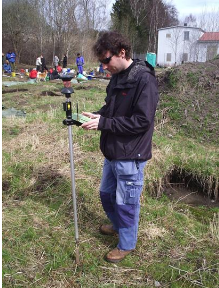
Figur 10. Prismastång med handdator (Wikipedia – Totalstation 2011).
