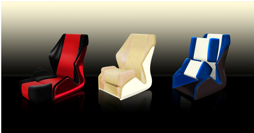
Figur 87. Stolskonceptet med tre olika material- och färgval samt med nedfällt- och uppfällt benstöd (till vänster och mitten i figuren). Sits och benstöd uppfällt till det nya halvstående läget ses till höger i figuren.
