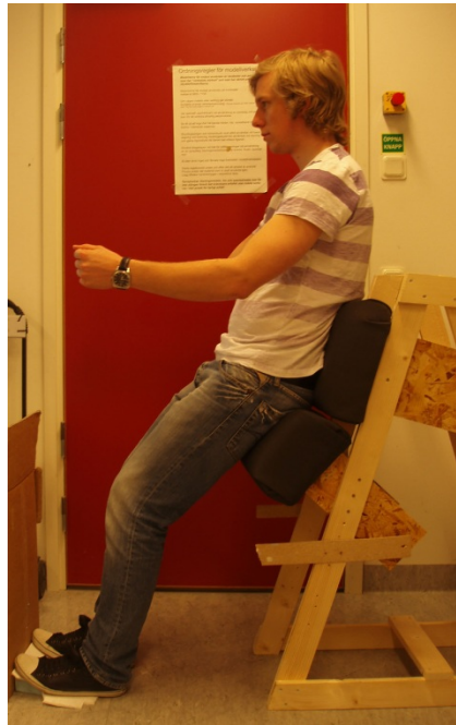
Figur 63. Körställningsprototypen i sitt slutgiltiga läge, vilket är mer stående än tidigare tänkt för att ge god aktiv körställning och för att utgöra en stor skillnad i jämförelse med den höga sittställningen.
