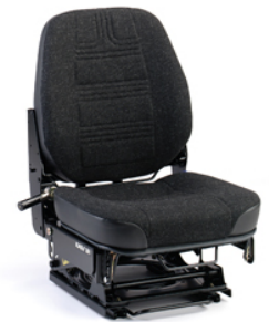
Figur 31. KAB 301 med mekanisk fjädring och hydrauliska dämpare på
