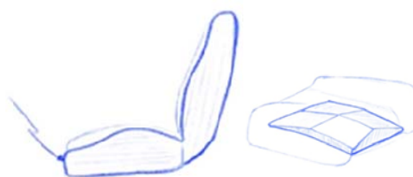
Figur 59. Sidledsstöd. Ett hårt skal till vänster, samt ett kilformat skum integrerat i sitsen till höger.
