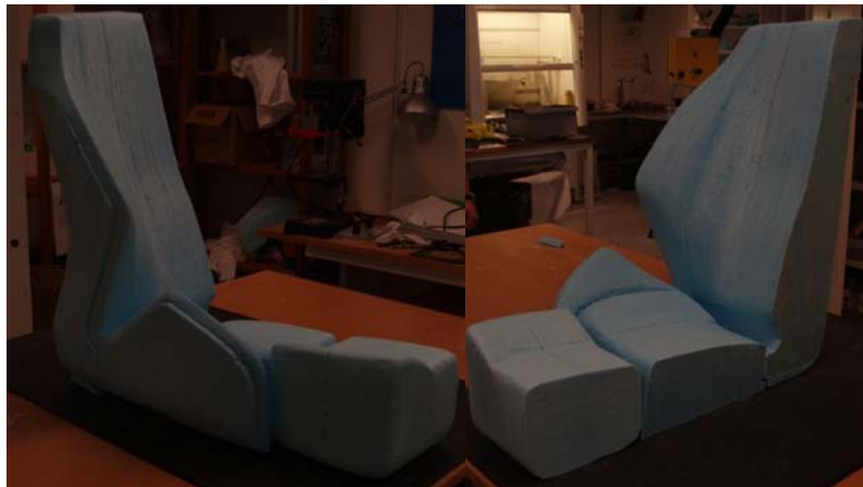
Figur 83. En skissmodell i fullskala gjordes för att verifiera formen och för att kunna få fram ett slutgiltigt formkoncept.
