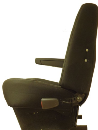
Figur 24. Stolsprototyp med mellanhög rygg och ett eftermonterat armstöd på ena sidan och bälte för anpassning till yrkesbruk.
