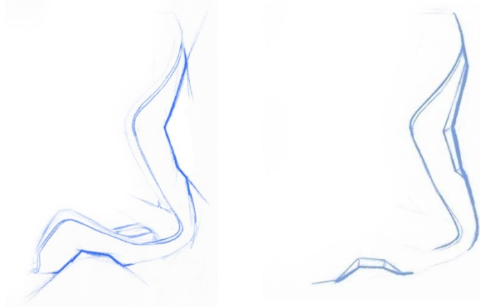
Figur 79. Urgröppningar i stolen gör stolen mer "slimmad" eftersom att stolens yttersida följer stolens profil.
