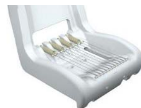
Figur 33. Attwoods stomme och dynamiska system bestående av ett fjäderupphängt galler.
