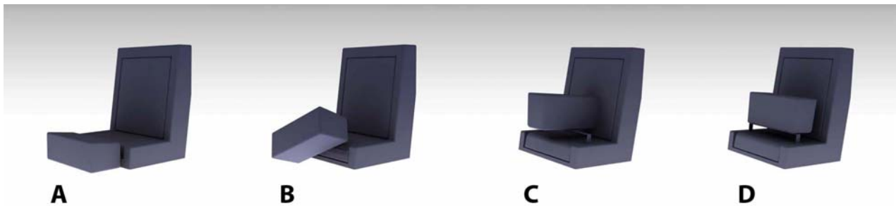
Figur 54. Jockey med roterbart benstöd. A till C beskriver hur benstödet roteras in mellan användarens ben för att bli en ”jockeystol”. D beskriver hur benstödet ser ut ”vanligt” i uppfällt läge.
