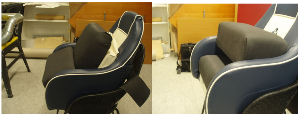
Figur 57. Funktionskonceptet på den förhöjda körställningen: Infällbart benstöd, med vissa modifikationer (sitsens ovansida utåt i det uppfällda läget). Till höger ses benstödet i det uppfällda läget för en förhöjd sittställning.
