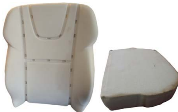
Figur 27. Skillnaden mellan formgjutet skum till vänster och skuret skum till höger.
