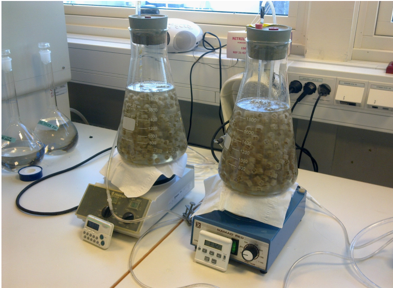
Figur 5. Bild på hur denitrifikationskapacitetstester i denna studie såg ut. 2 liters e-kolvar med kvävgasinblåsning och magnetomrörare. Kolvarna fyllda med bärrmaterial från försökslinjerna och vatten från ED-anläggningen.
