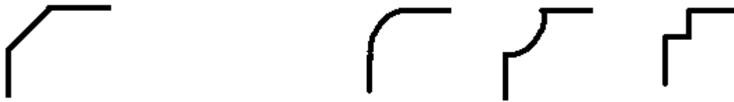
Figur 4.1 Olika exempel på fasningar där den första till vänster är rätt och de övriga tre till höger är felaktiga.
