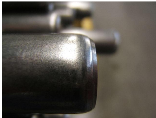
Figur 4.2 Exempel på felaktig fasning av en rundstång.
