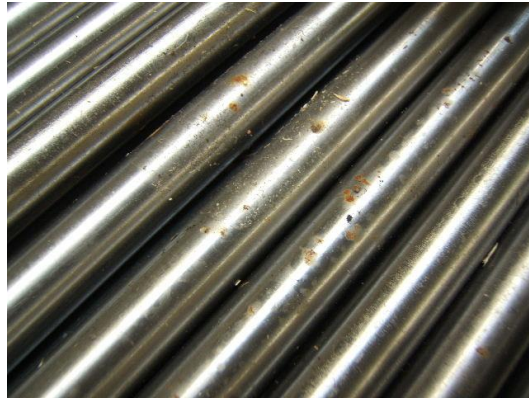
Figur 4.5 Exempel på rostigt stångmaterial, [5]
