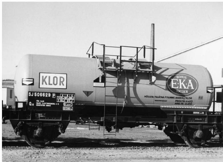
Anm.: Tankvagnen har en lastkapacitet på 27 ton. Källa: Eka Chemicals.
