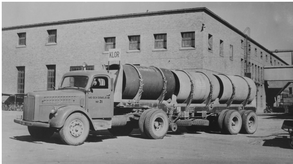
Anm.: Scania-Vabis L20 med semitrailer från Fruehauf, lastad med tre 3-tonsfat för klor, årsmodell 1948. Källa: Domsjö Klor AB:s arkiv, volym F3:4.
