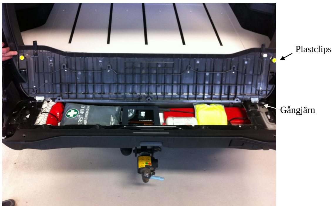
Figur 6.17 - Nödsituationslådan med diverse utrustning
