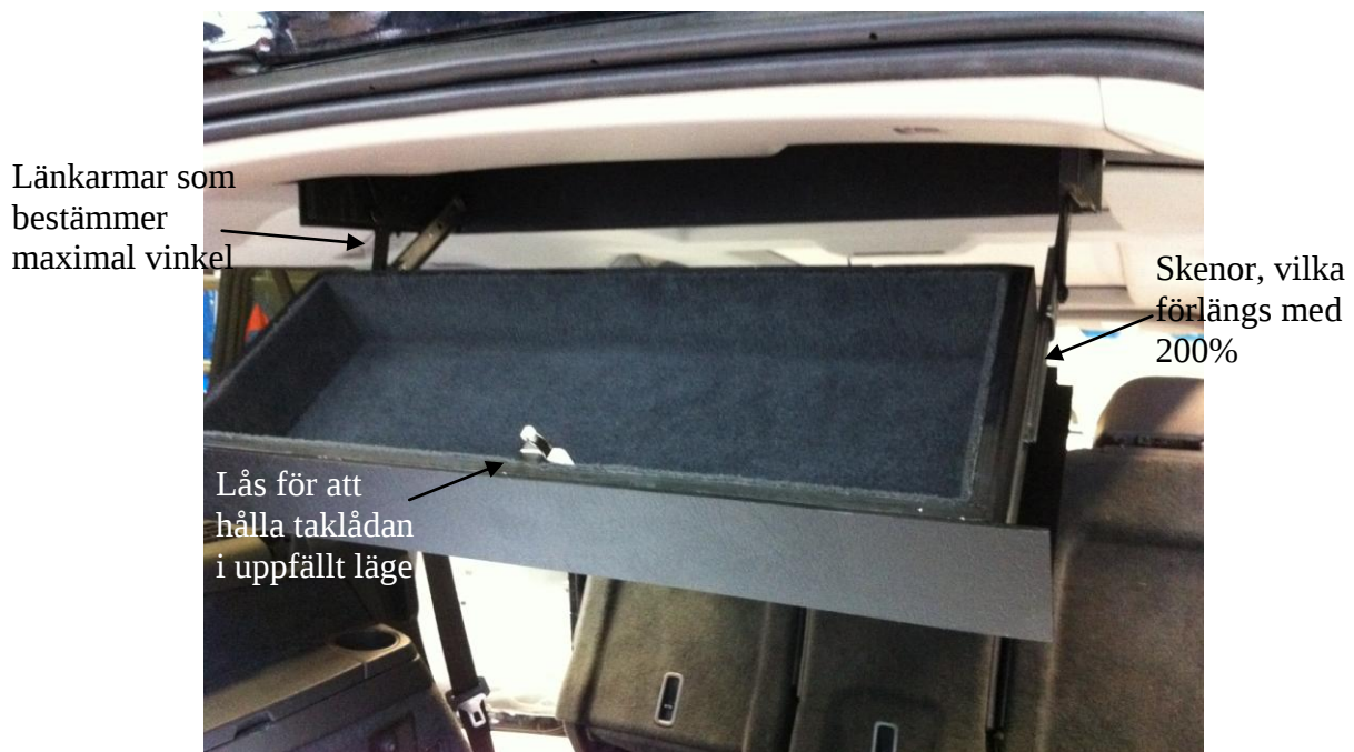
Figur 6.19 – Takfacket monterat i bilen
