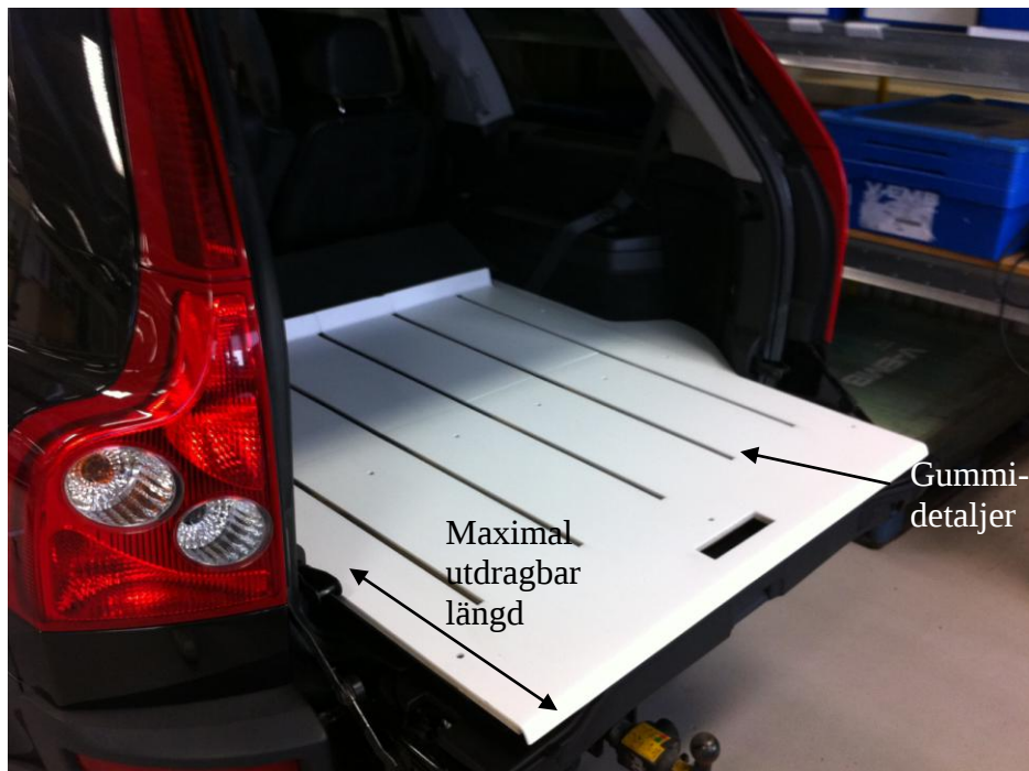
Figur 6.13 - Lastgolvet i verklig modell i utdragen position
