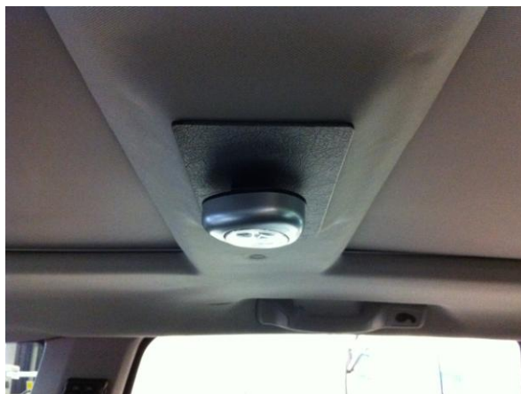
Figur 6.11 – Prototypen av lampan fastsatt i innertaket
